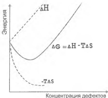
Рис. 16. Энергетические изменения, происходящие при образовании дефектов в совершенном кристалле
