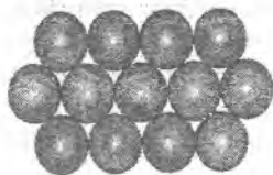
Рис. 13. Плотнейшая упаковка шаров в пределах одной кристаллической плоскости
