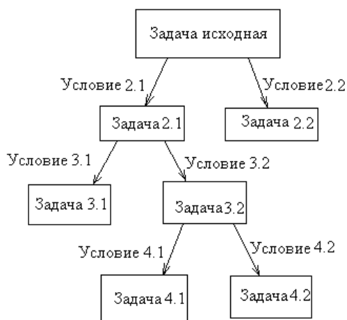
Рис. 6.1. Схематическое изображение решения метода «ветвей и границ»
