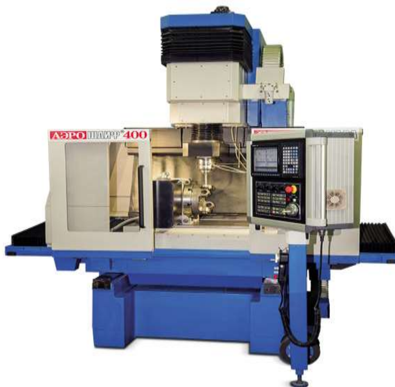
Рис. 3.4. Вертикальный координатно-шлифовальный станок особой точности мод. Аэрошлиф 400(производитель ЗАО «Стан-Самара» г. Самара)
