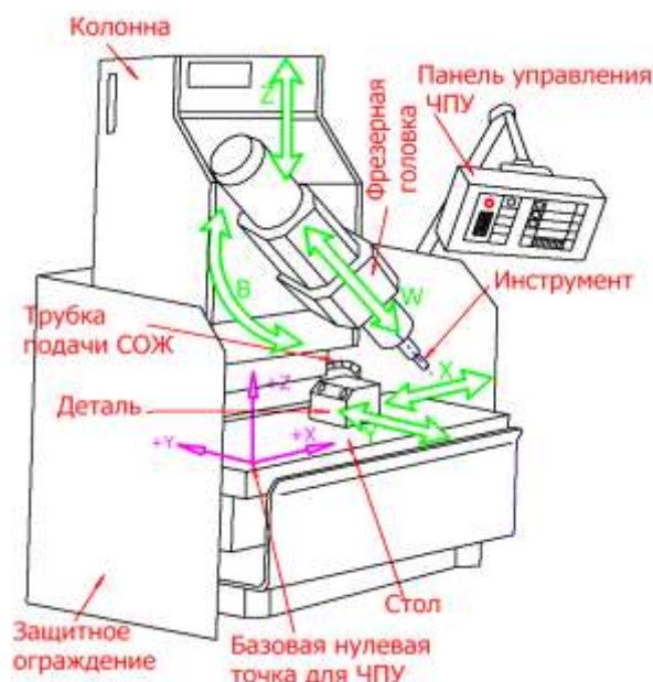
Рис. 3.1. Возможная схема движений исполнительных органов станка при использовании пятикоординатной системы ЧПУ. На рисунке приняты обозначения: X , Y , Z – линейные перемещения в Декартовой системе; W – линейная координата вдоль оси вращения шпинделя станка; B – угловая координата поворота шпинделя в плоскости zOx
