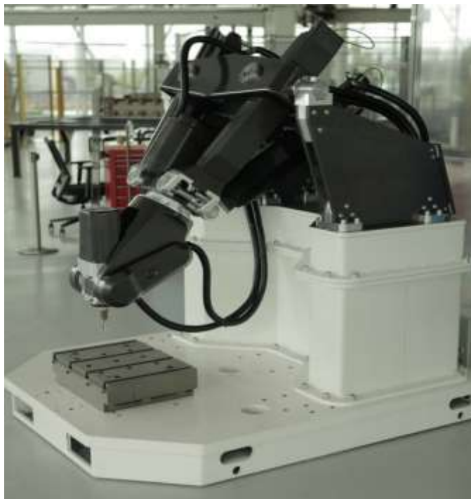
Рис. 3.3. Фрезерно-сверлильный станок XMini с параллельной кинематикой (производитель Exechon, GmbH , Германия)
