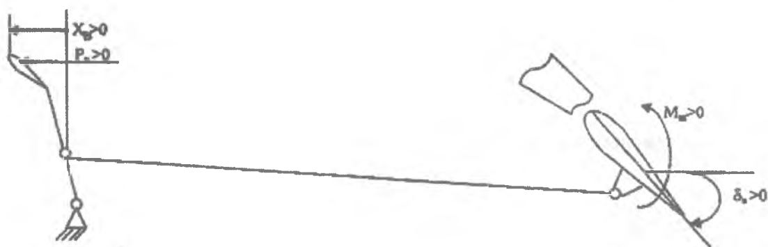
Рис. 5.1. Кинематика управления тангажом самолета нормальной схемы
