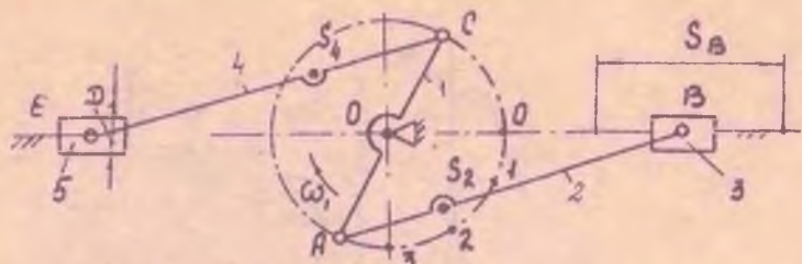
Р и с. 14.1. Кинематическая схема механизма двигателя
