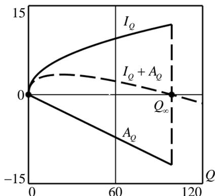
Рисунок 7 – Графики функций  $A_Q$ ,  $I_Q$  и  $A_Q + I_Q$ . Сплошные линии соответствуют функциям  $A_Q$  и  $I_Q$ , штриховая линия соответствует функции  $A_Q + I_Q$ . Расчетные значения:  $P = 10$ ;  $a = 0,45$ ;  $A = 0,12$ ;
