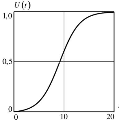
Рисунок 10 – График функции  $U = U(t)$ , построенный по формуле (2.4.7). Расчетные значения:  $a = 0,005$ ;  $b = 0,5$ ;  $U_{\infty} = 1$
