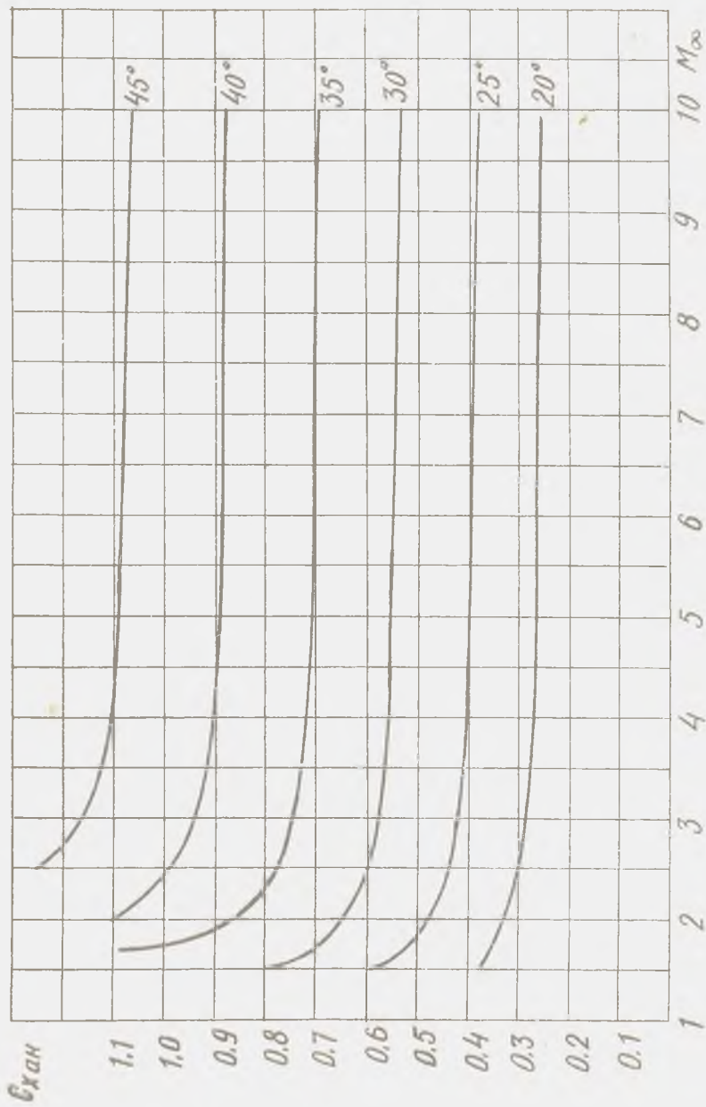
Рис. 20,б. График для расчета сопротивления носовых частей конической формы в зависимости от угла полураствора конуса
