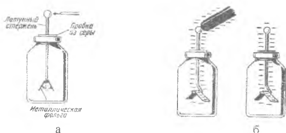
Рисунок 5 - Лепестковый электроскоп (а), демонстрация электризации соприкосновением (б)
