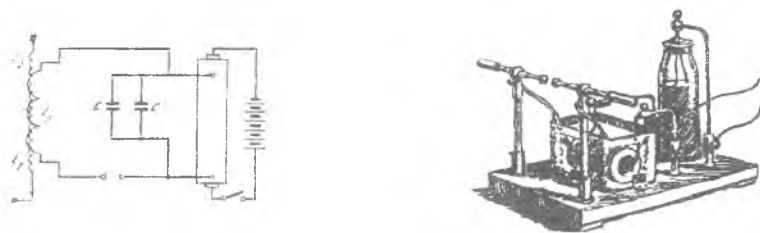
Рисунок 22 - Схема и внешний вид резонанс-трансформатора Теслы (1891)
