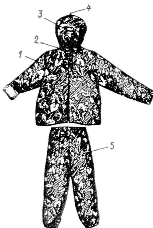
Рис. 2.22. Защитный костюм КЗК: 1 – куртка; 2 – стяжка; 3 – капюшон; 4 – петля; 5 – брюки
