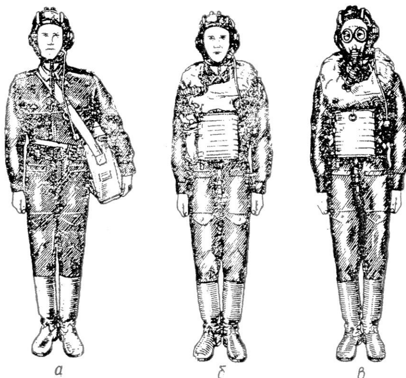
Рис. 2.19. Аппарат ИП-5: а – в положении «походном»; б – в положении «боевом»; в – в положении «наготове»
