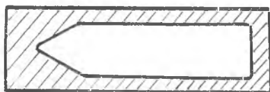
Рис. 13. Схема контейнера для зарождения одного центра кристаллизации
