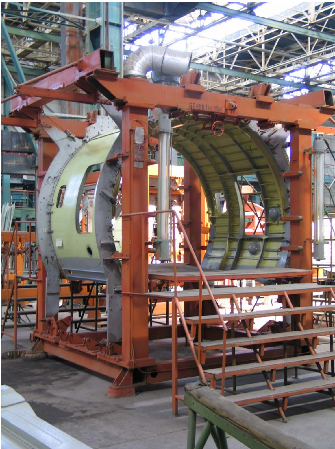
Рис. 10.5. Приспособление для сборки отсека между шпангоутами 23-27 Ф-2
