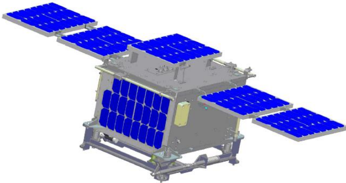
Рис. 8.23. МКА микро-класса для проведения медико-биологических экспериментов в условиях низкого уровня микрогравитации
