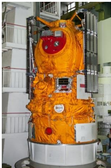
Рис. 8.1. Размещение МКА «АИСТ» на борту КА «БИОН-М» [14]
