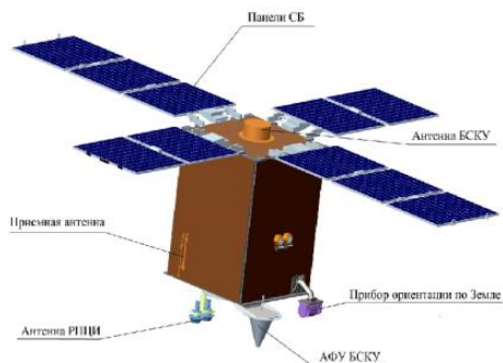
Рис. 8.25. Модернизированный МКА серии «АИСТ-2», оснащенный электрореактивной двигательной установкой
