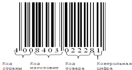
Рис. 28. Пример этикетки с кодом EAN-13
