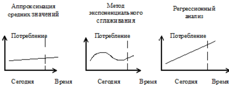
Рис. 21. Методы стохастического определения потребности
