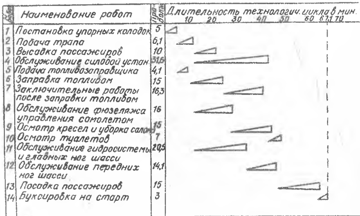
Рис.9. График технологического цикла технического обслуживания самолета на кратковременной стоянке при параллельно-последовательном виде сочетания работ
