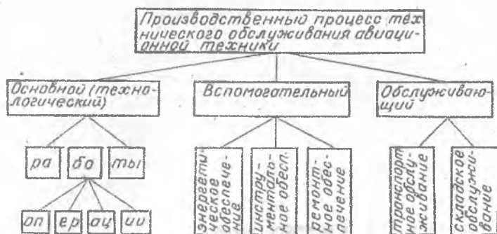
Рис.2. Структура производственного процесса технического обслуживания авиационной техники
