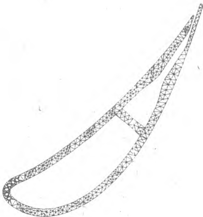
Рис. 14. Пример разбиения поперечного сечения лопатки сетью конечных элементов
