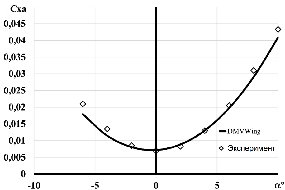
Рис. 1.2.14 Зависимость c_{xa}(\alpha) , рассчитанная в программе «DMVWing», и экспериментальная зависимость ( \lambda = 5 , \eta = 1 , \bar{c} = 12\% , \chi_{n.k} = 0^\circ , S = 0,45 \text{ м}^2 , V_\infty = 50 \text{ м/с} , Re = 10^6 ) [31]
