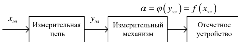
Рис. 2.16. Обобщенная структурная схема электромеханических приборов
