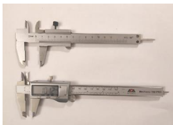
Рис. 1.6. Фотография механического и электронного штангенциркулей
