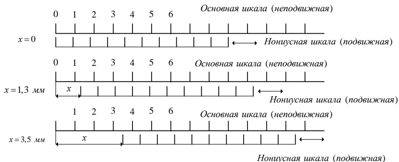
Рис. 1.5. Принцип измерения методом совпадения
