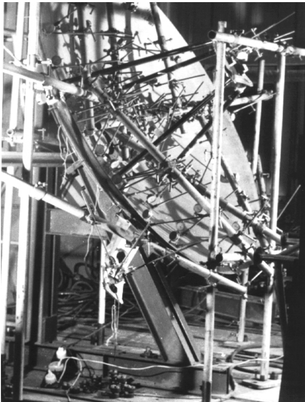
Рис. 4.12. Установка датчиков перемещений при испытаниях сферического сегмента
