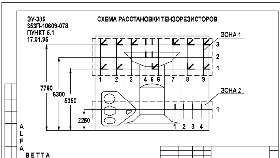
Рис.4.30. Форма выдачи АИК СИГМА-М схем размещения тензорезисторов
