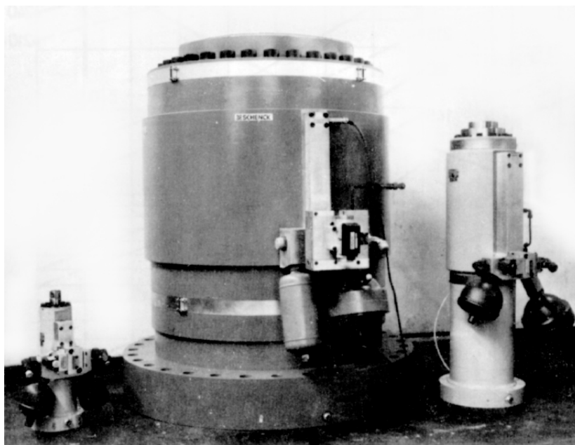
Рис. 6.17. Внешний вид гидроцилиндров с сервоблоками фирмы «Schenck» PL16K; PLz7.5N; PL25OP
