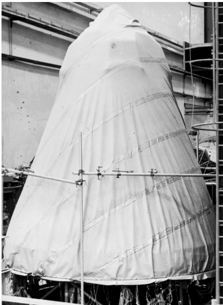
Рис. 4.8. Коническая часть ГО в чехле для проведения испытаний на внешнее давление вакуумным методом
