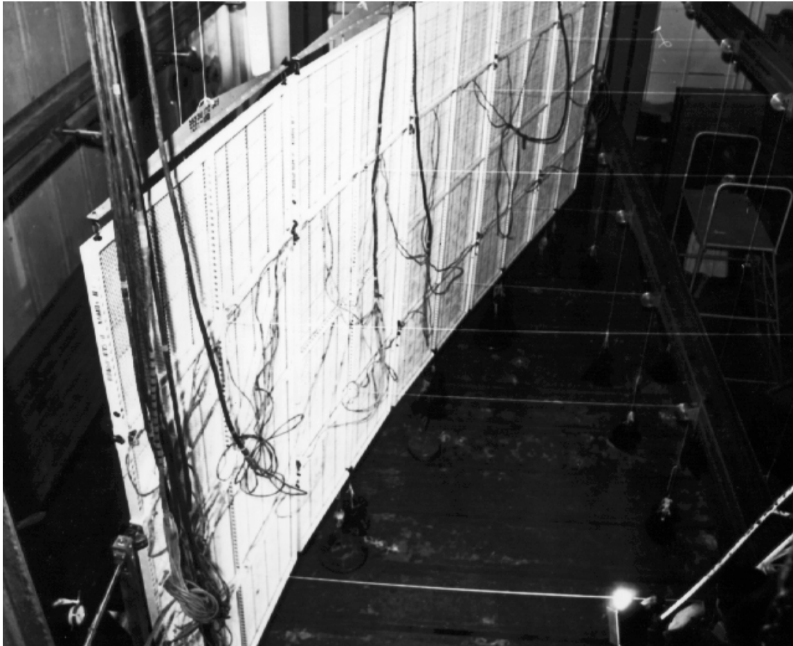
Рис. 4.11. Общий вид стенда для испытания БС в раскрытом состоянии
