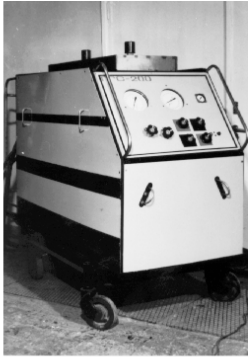
Рис. 4.15. Пневмогидравлическая станция типа ПГН-250
