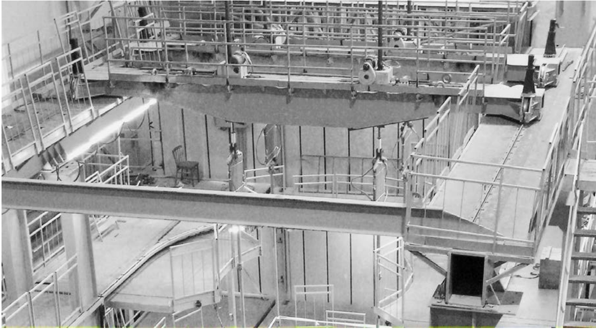
Рис. 6.34. Общий вид системы амортизационной подвески изделия в испытательном стенде
