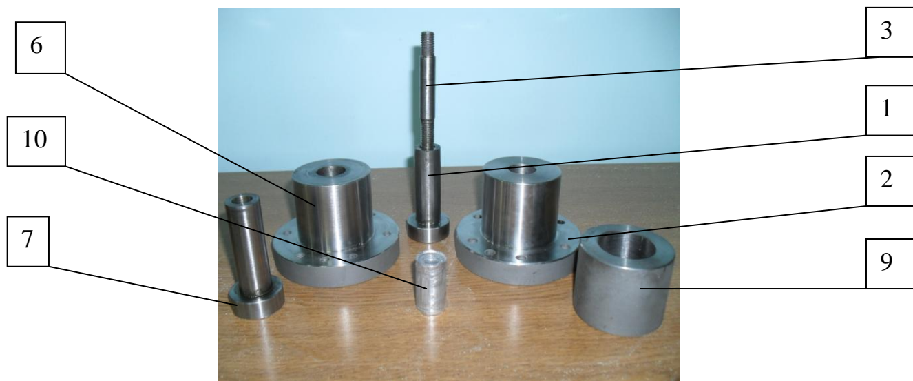
1- верхний пуансон, 2 – верхняя часть контейнера с пояском, 3 – оправка, 6 – нижняя часть контейнера, 7 – пуансон нижний, 9 – опорное кольцо верхнее, 10 – заготовка
