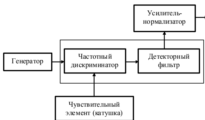
Рис. 6.2. Функциональная схема вихретокового датчика
