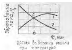
Рис. 10. Определение термоокислительной стабильности масла по интенсивности лакообразования: 1 — лак, 2 — рабочая фракция
