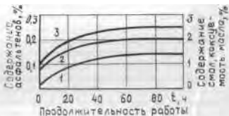
Рис. 19. Изменение показателей термоокислительной стабильности масла в зависимости от выработки: 1 — асфальтены; 2 — смолы; 3 — вязкость
