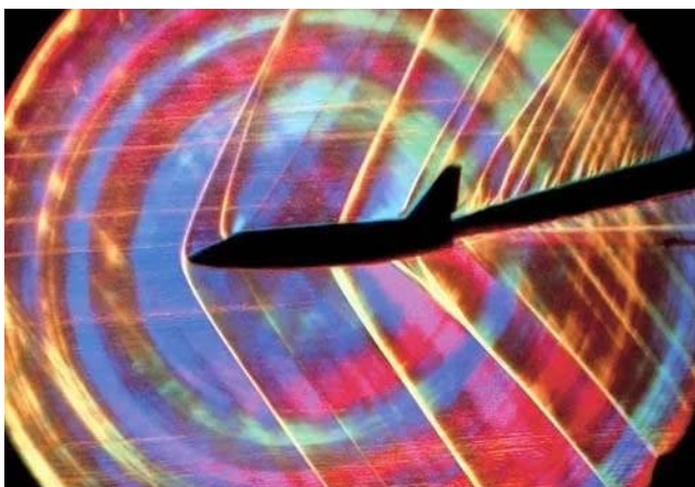
Рис. 38. Пример визуализации обтекания теневым методом: а – модель возвращаемого аппарата, расположенная над пластиной, б – иллюстрация цветного изображения [28]
