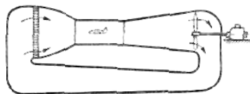
Рис. 8. Схема аэродинамической трубы с замкнутым потоком, с одним обратным каналом [24]
