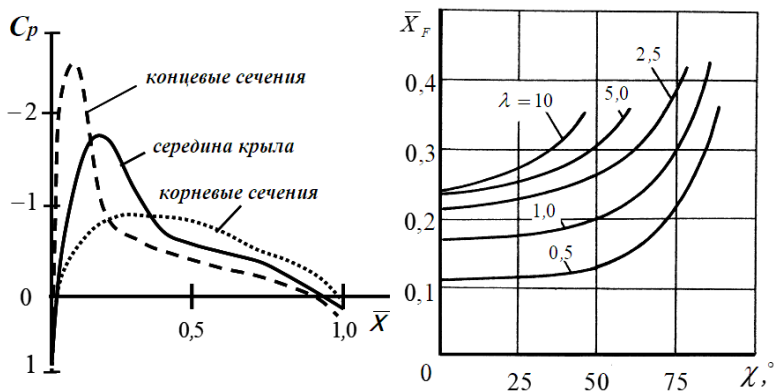
Рис. 55. Влияние стреловидности на распределение давления в различных сечениях крыла и положение фокуса
