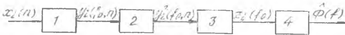
Рис. 2.1. Структурная схема одного канала цифрового анализатора спектра; 1 — узкополосный цифровой фильтр, 2 — квадратичный преобразователь, 3 — сумматор, 4 — блок усреднения по ансамблю реализаций
