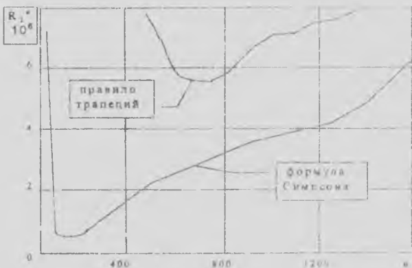
Рис. 5.6. Зависимость суммарной ошибки (ограничения и округления) от количества интервалов интегрирования
