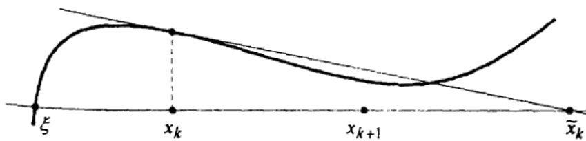
Пример поведения гибридного метода Ньютона-половинного деления, когда x_{k+1} дальше от корня \xi , чем x_k
