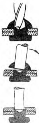
Фиг. 44. Приемы удаления дефектных заклепок.
