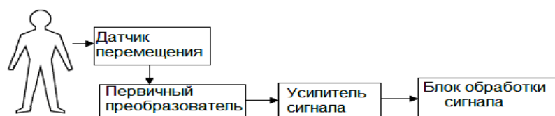
Рисунок 8 – Обобщенная структурная схема сфигмографического ИП артериальной пульсации крови
