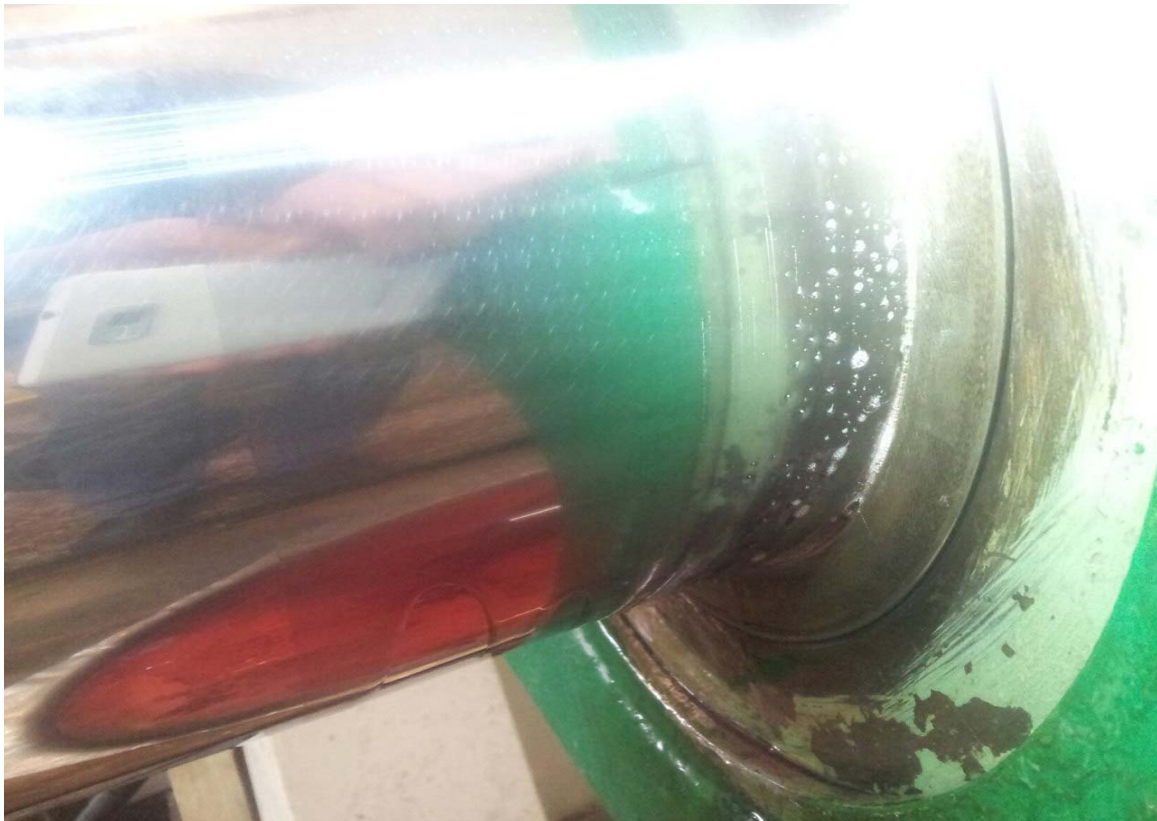
Рис. 1. Утечки азота через пористую структуру хрома из полости оправки с давлением азота 15 МПа
