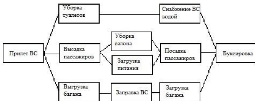
Рис. 1 Технологический процесс обслуживания ВС
