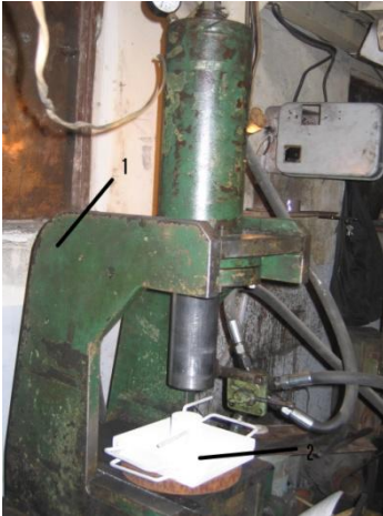
1 - гидравлический пресс; 2 - штамповая оснастка
