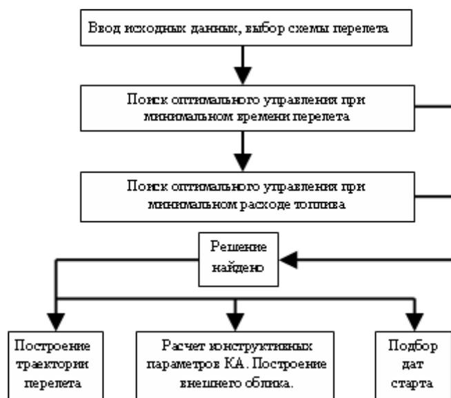
Рисунок 1. Укрупненный алгоритм работы программного комплекса
