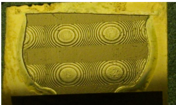
Рисунок 1. Фотография ДОЭ, полученного на основе ЖФПК
