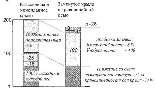
Рис.2. Диаграмма изменения весовых составляющих при переходе к схеме замкнутого крыла
