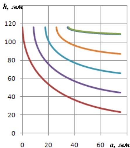
Рис.2. Спроектированный меридиональный профиль РК радиально – осевой турбины для регистровой системы наддува дизеля Д21-26ДГ
