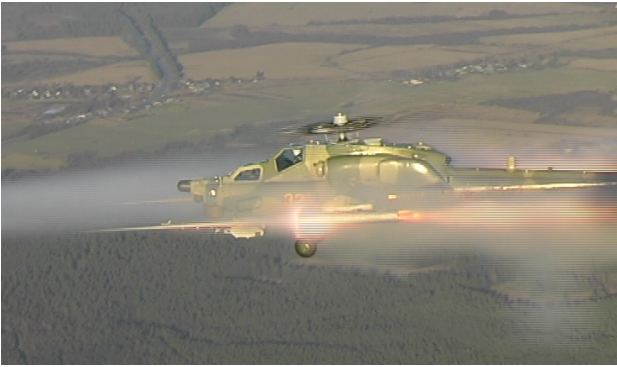
Рис. 1. Распространение факела ракеты при стрельбе залпом
