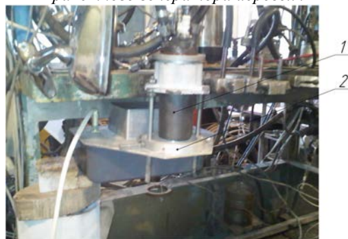
Рис. 3. Ракетный генератор аэрозоля с устройством контроля дисперсной фазы:
