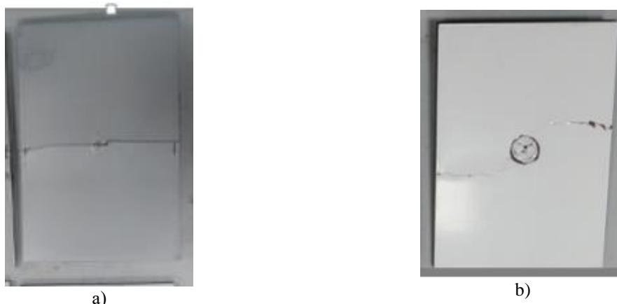
Рисунок 1 – Результаты испытания образцов на сжатие после удара (для энергий удара 6,7 Дж на 1 мм толщины): а) гибридные образцы; б) не гибридные образцы
