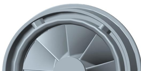
Рисунок 1 – Камера перепуска с направляющими лопатками
