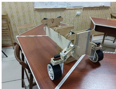
Рисунок 2 - Сборка ходовой части планетохода
