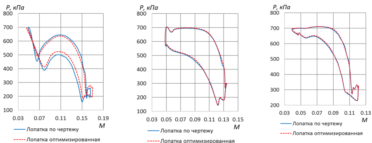
Рисунок 6 – Распределение давления по профилю в контрольных сечениях по высоте пера лопатки
