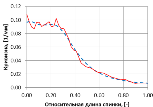
Рисунок 2 – Эпюры кривизны: — базового профиля - - - оптимизированного профиля
