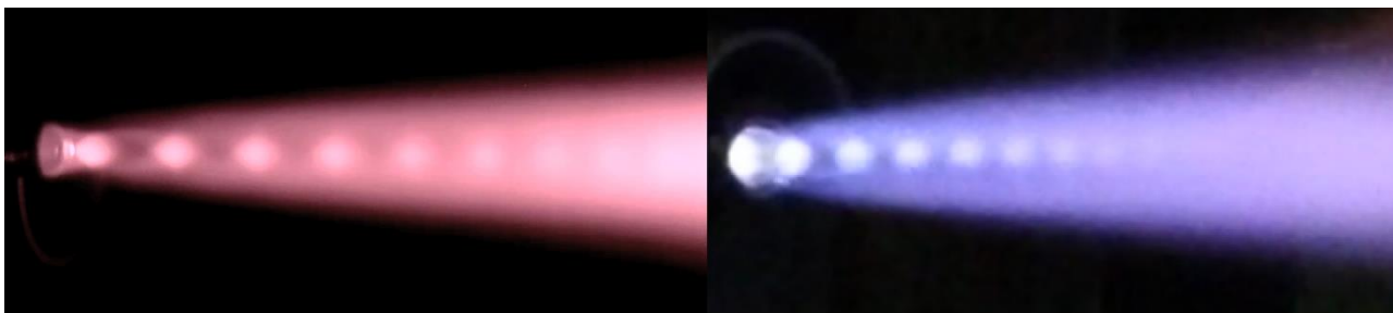
Рисунок 2 – Работа функционального макета камеры с регенеративным охлаждением, слева фото в ближней инфракрасной области спектра, справа в видимом диапазоне
