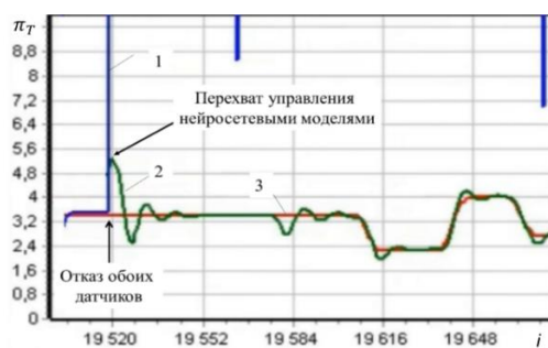
Рисунок 2 – процесс определения и замены неисправного датчика нейросетевой моделью 1 – значение полного давления с отказавших датчиков; 2 – Отклик нейросетевых моделей; 3 – Заданное значение полного давления.
