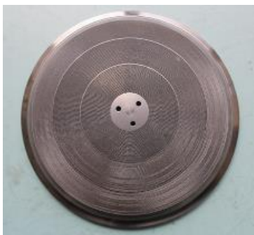
Рисунок 1 - Металлический фильтр, изготовленный методом электронно-лучевой обработки (78000 отверстий диаметром 0,3 мм в детали сферической формы толщиной 1,5 мм)
