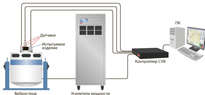
Рисунок 1 – Схема соединения оборудования для испытаний на усталость
