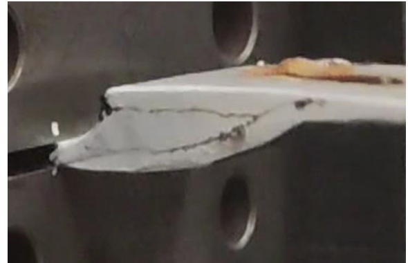
а) б) Рисунок 1 – Схема испытаний образца на вибростенде (а); вид трещины в конструктивно подобном образце фланца (б)
