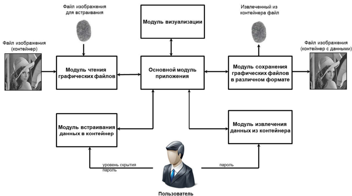
Рис. 3. Структура разработанной автоматизированной системы защиты
