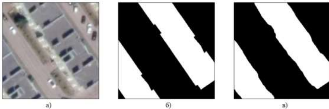
Рис. 1. Результат применения нейросетевого алгоритма (а – исходное изображение, б – маска изображения, в – результат семантической сегментации)
