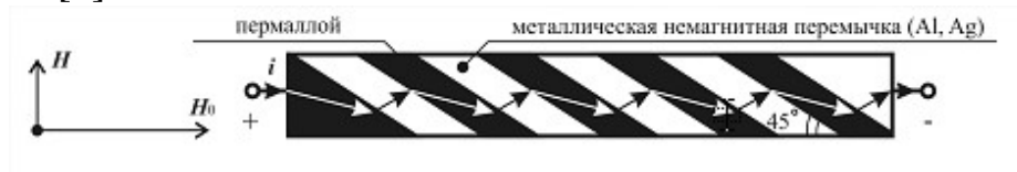
Рис. 1. Структура типа «barber-pole» единичного AMР-элемента
