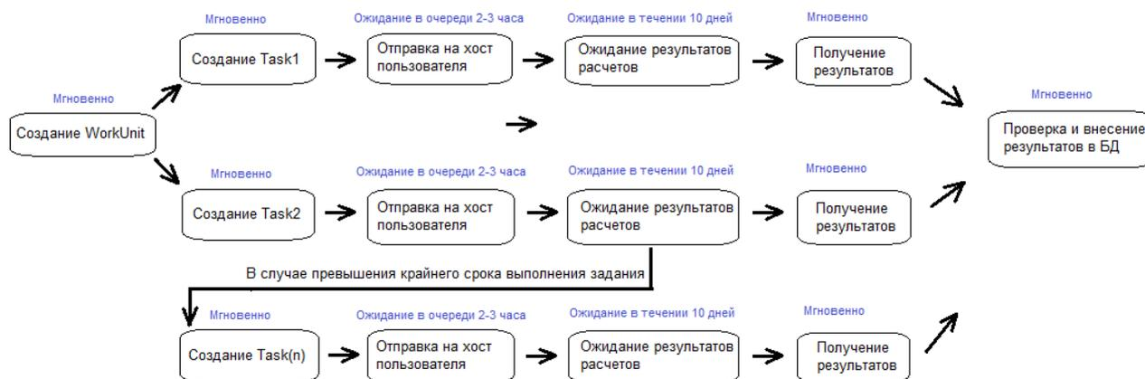
Рис. 1. Схема работы с дедлайном в проектах добровольных вычислений
