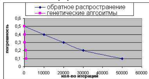
Рис. 3. Сравнение результатов работы генетических алгоритмов и алгоритма обратного распространения.
